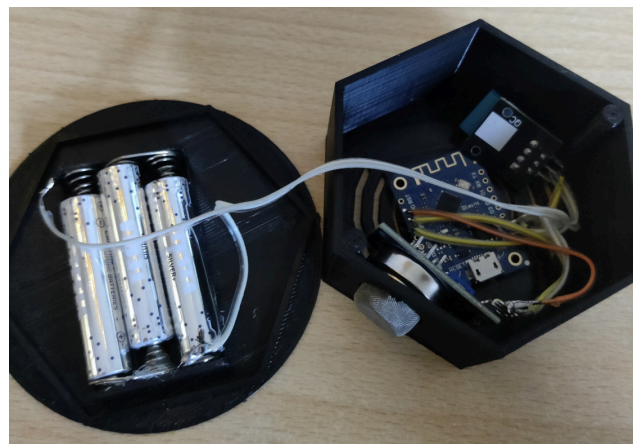
Obr. 9 Skonštruované zariadenie na báze Arduino dosky
