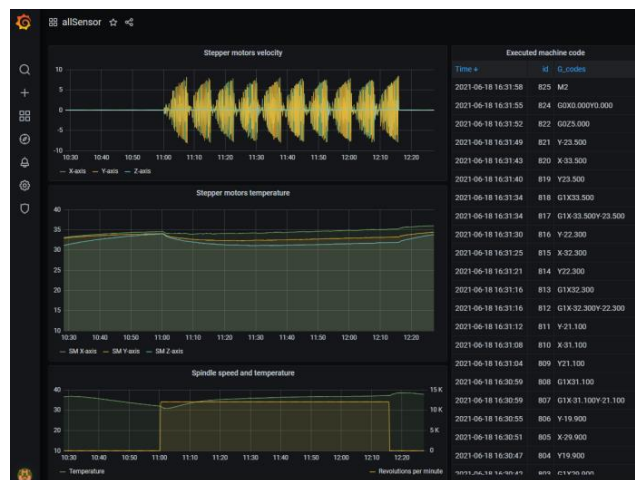
Obr. 9 Grafy teplôt, rýchlosti pohonov a tabuľka G-kódu
