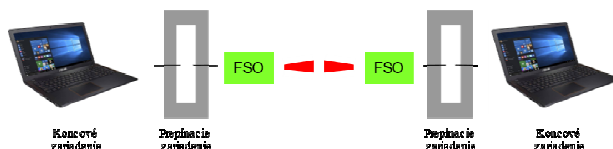
Obr. 1 Princíp komunikácie FSO systému.
